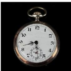
Taschenuhr, um 1910, 800 Silber (punziert, Zwischendeckel Metall), Gesamtgewicht 61g, Durchmesser 47mm, Zylinderwerk, läuft an, Funktion nicht geprüft, Zifferblatt Emaille mit einem leichten Riss zwischen 10/11 und 2/3 Uhr, Zeigerfarbe nicht original
